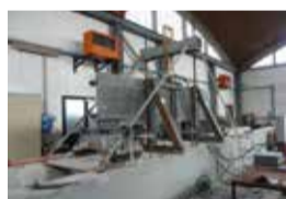
Test sur plancher mixte bois-béton posé sur la tranche en vertical pour vérifier la rigidité du plan, indispensable pour transmettre au murs la force la sismique.
