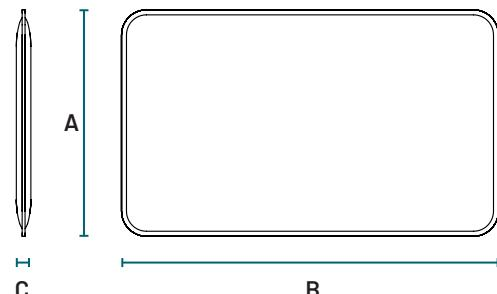
Pannello fonoassorbente **PHONOLOOK DESIGN ECO** mod. Office **DESK** avente spessore 30 mm, dimensioni AxB, indicato per la riduzione del riverbero negli uffici costituito da un pannello in fibra di poliestere termoformato a densità variabile. Le facce a vista sono a sezione convessa, rivestite da tessuto in poliestere autoestinguente Trevira Cs®, disponibile in una vasta gamma di colori. Su richiesta è possibile stampare immagini o motivi mediante **stampa UV** sul tessuto di rivestimento.
